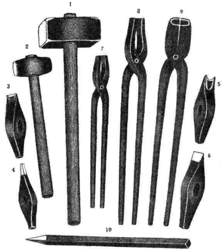
Рис. 1. Большой или боевой молотъ, желѣзный, съ гладкими, наваренными сталью и закаленными ударными поверхностями. Вѣсъ его около 10 фунт.
