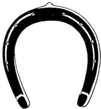
Рис. 54. Передняя подкова съ пяточными шипами.
