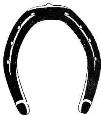
Рис. 55. Задняя подкова съ пяточными шипами.
