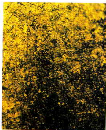
Поверхность удила из нейзельбера 65 % медь, 12-15 % никель, остальное - цинк
