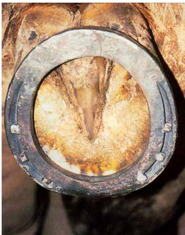
**Рис. 375. Яйцевидная подкова (вид с подошвы).** Яйцевидные подковы весьма сложны в изготовлении, и требуют индивидуальной подгонки опытным ковалем. Подкова совершенствует движения лошади, но лошади зачастую отрывают и теряют эти подковы, заступая задней ногой. Для повышения скорости переворота на зацепе подковы сделан перекаат.
