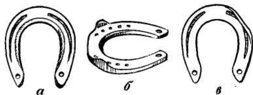
Рис. 9. Подковы: а) передняя; б) задняя; в) передняя подкова для за- секающихся лошадей
