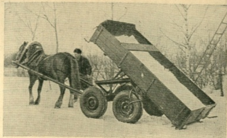
Рис. 57. Новая четырехколесная одноконная грузовая повозка-самосвал на пневматических шинах, сконструированная Всесоюзным научно-исследовательским институтом коневодства.
